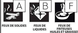
Le chiffre qui précède la lettre dans la partie supérieure de la sérigraphie indique la classification des foyers et donne l'efficacité de l'extincteur sur ces derniers. Plus le chiffre est élevé, plus l'efficacité est importante. Les températures limites d'utilisation données sur l'appareil doivent être obligatoirement respectées.
