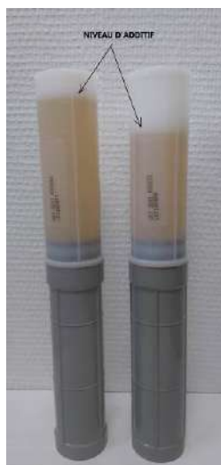
Indication de la contenance d'additif et contrôle du niveau du container d'additif
